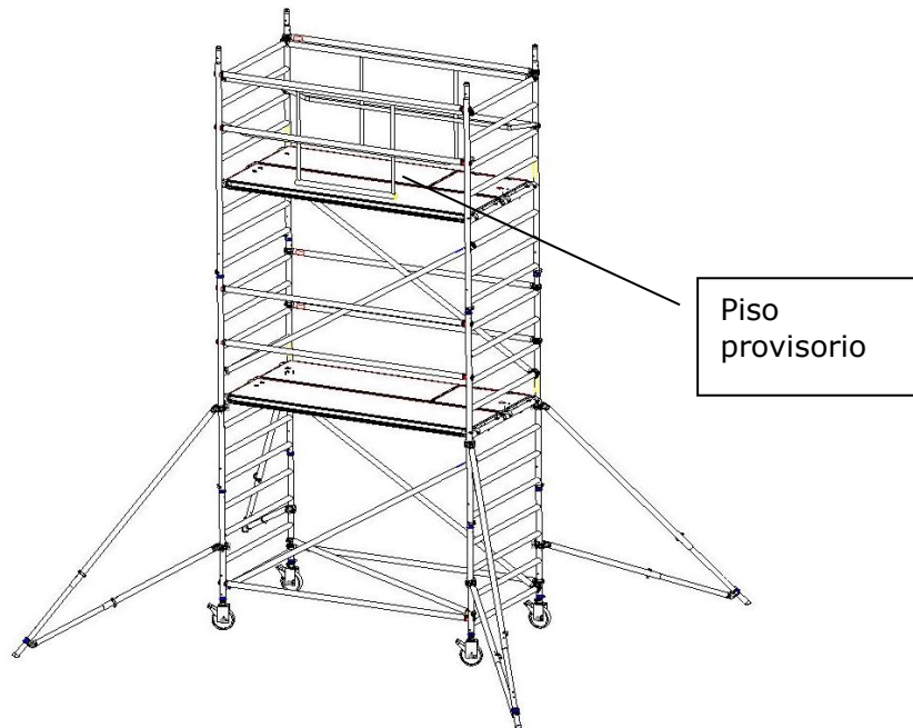
Piso montado com resguardo provisório
